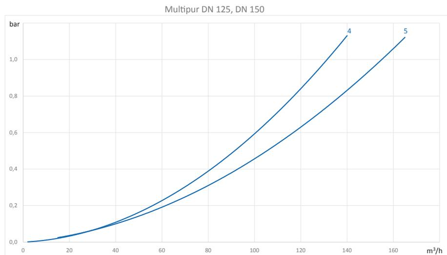
1 = Multipur DN 65 // 2 = Multipur DN 80 // 3 = Multipur DN 100 // 4 = Multipur DN 125 // 5 = Multipur DN 150
